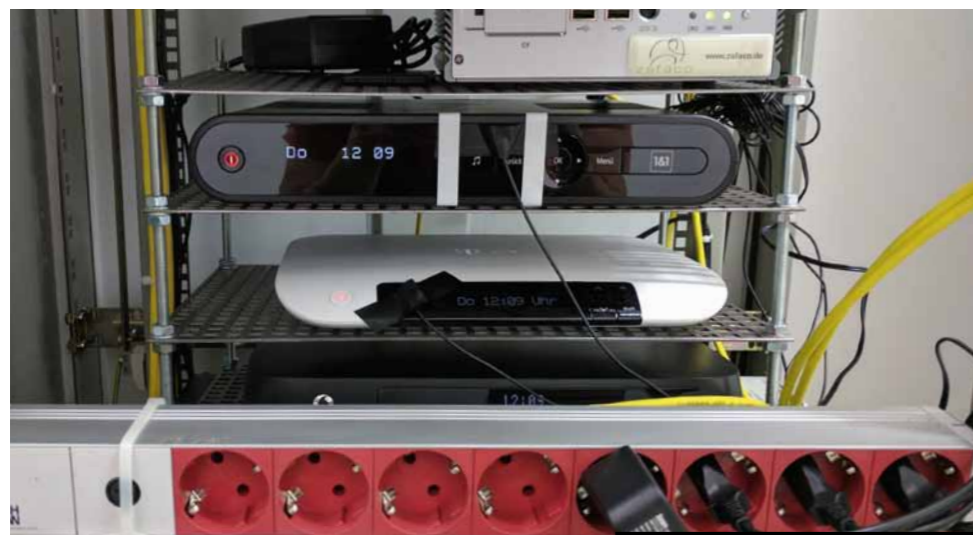
Zappen per Automatik: Die Original-Set-Top-Boxen der Anbieter wurden automatisiert gesteuert, die von ihnen gelieferte Bildqualität wurde von spezialisierten Testsystemen analysiert.
